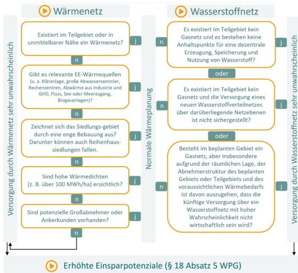
Abbildung 2-1: Prüfschema zur Entscheidungsfindung hinsichtlich der Durchführung einer verkürzten Wärmeplanung [7]
