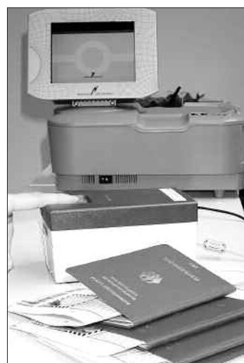
Für den ePass werden zwei Fingerabdrücke benötigt. Die Abdrücke werden bei der Passbeantragung mithilfe des Scanners aufgenommen.
